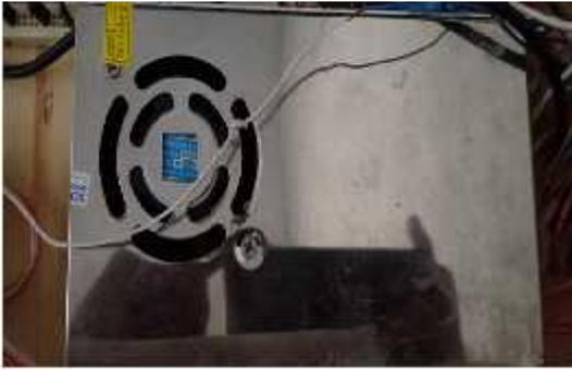
Gambar 9. Power Supply 220 Volt pada Maket Rumah Pintar
