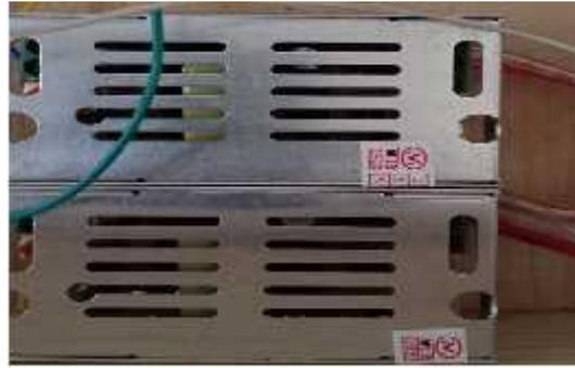
Gambar 10. Power Supply 5 Volt pada Maket Rumah Pintar
