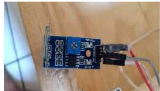
Gambar 14. Sensor Reed Switch pada Maket Rumah Pintar
