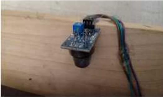
Gambar 17. Sensor Gas pada Maket Rumah Pintar
