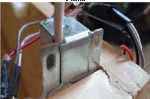
Gambar 15. Door Lock Solenoid pada Maket Rumah Pintar
