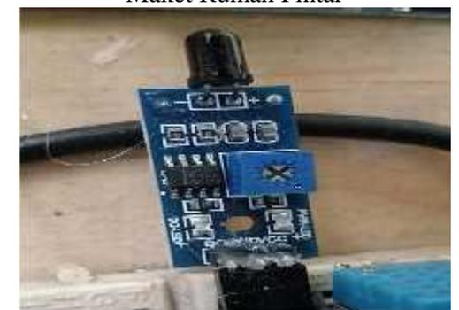
Gambar 16. Sensor Api pada Maket Rumah Pintar
